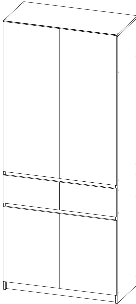
Максимальная нагрузка на шариковые направляющие до 10 кг (при равномерно распределённой нагрузке). Шкаф ОБЯЗАТЕЛЬНО крепить к стене. Шкафы между собой скрепить межсекционными стяжками.
