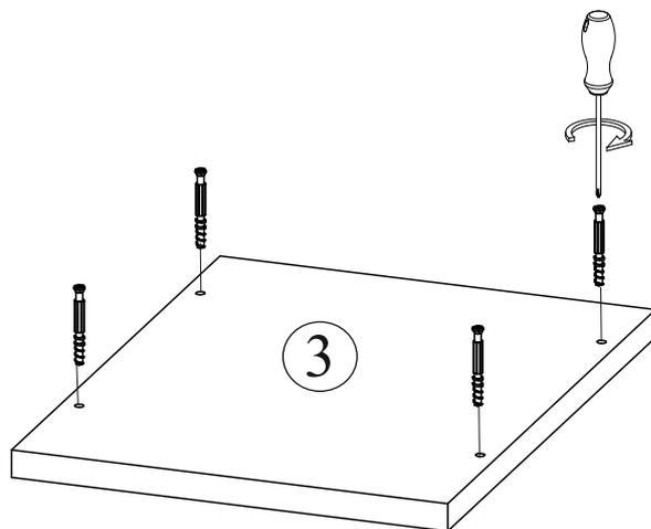
3. Соедините Боковины (дет. №1,2) с Нижней Крышкой (дет. №3) при помощи евровинтов. Затем присоедините Верхнюю крышку (дет. №4) при помощи эксцентриков и затяните их.
