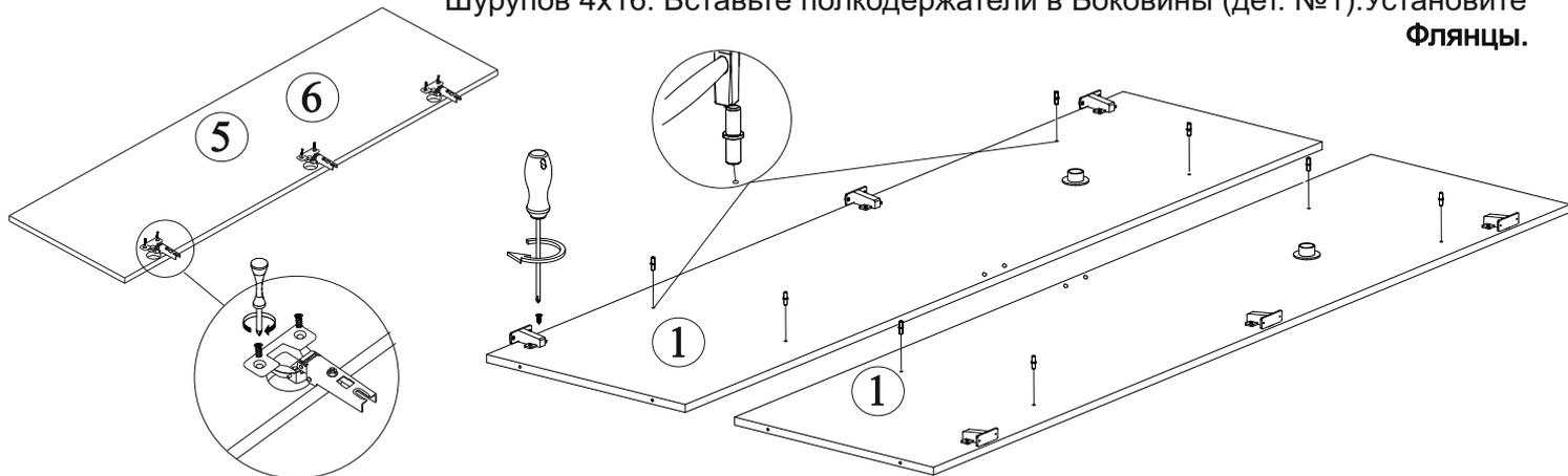
2. Соберите каркас шкафа соединив Крышки и Усиление (дет. №2,4) с Боковинами (дет. №1) при помощи евроинтов.
