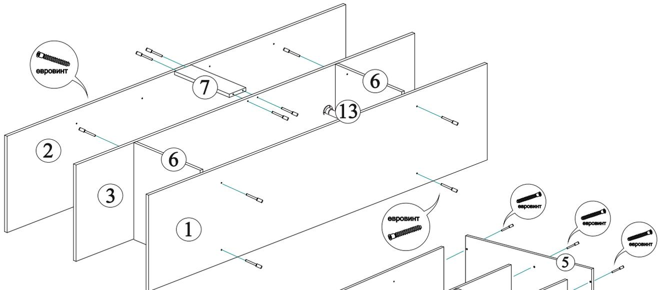
3. Присоедините Крышку и Дно (дет. №4,5) к собранному каркасу при помощи евровинтов.
