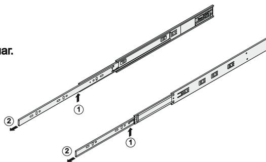
3. Закрепите саморезами внутренние подвижные планки направляющих к боковым стенкам ящика. Рекомендуется вкрутить один из саморезов в отверстие в форме звездочки
