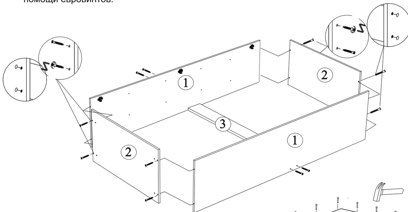
3. Выровняйте диагональ каркаса и прибейте Заднюю стенку ЛДВП ЛДВП (дет. №7) предварительно соединив их при помощи гвоздей. Установите Опоры при помощи евровинтов.
