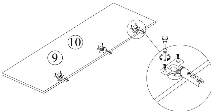
6. Установите Полки (дет. №8) на полкодержатели. Установите Створки на корпус Шкафа и отрегулируйте их. Установите магнитные отталкиватели.
