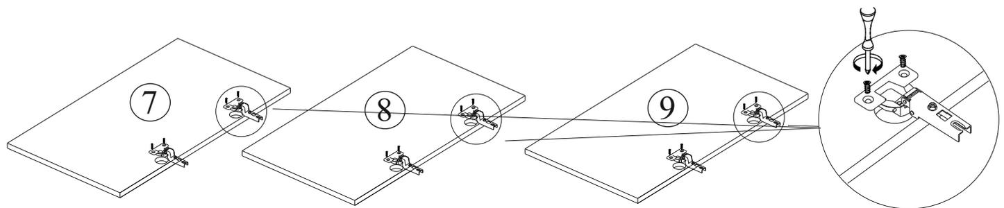
4. Соберите каркас комода соединив Бока и Перегородки (дет. № 1,2,3,4) с нижней крышкой (дет. №5) при помощи евровинтов а затем с верхней крышкой (дет. 6) затянув эксцентрики.
