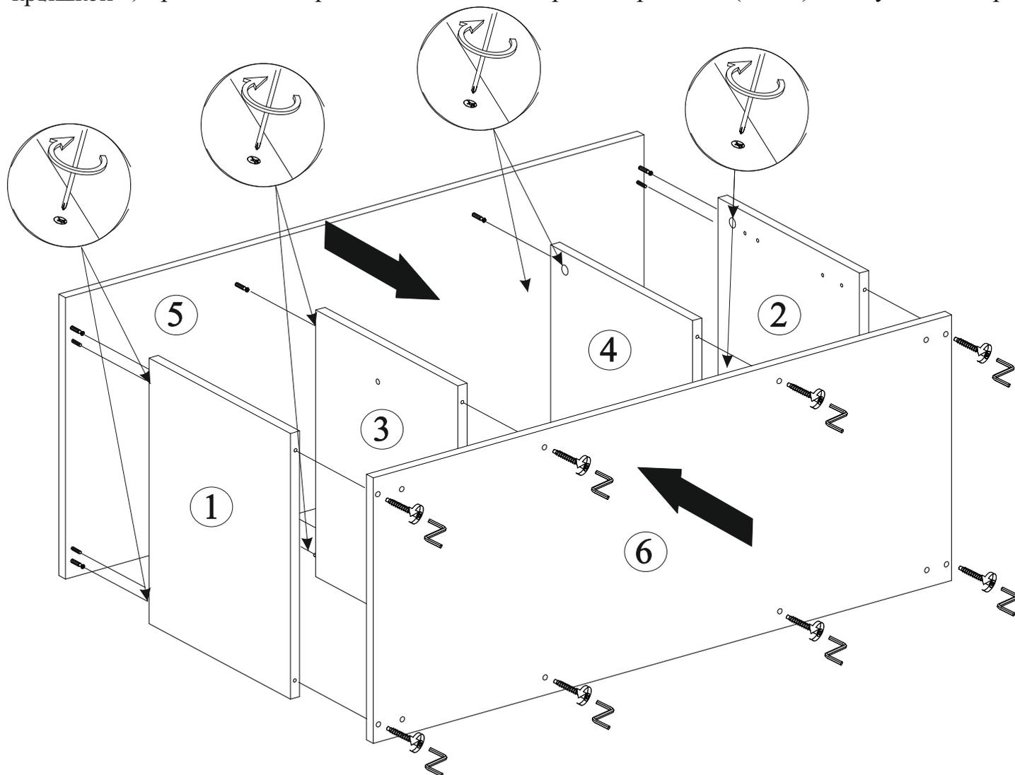
5. Вымерите диагональ и прибейте Заднюю стенку (Дет. №11) предварительно соединив их при помощи Соединителя (дет. №12) при помощи гвоздей. Прикрутите опоры Евровинтами изнутри.
