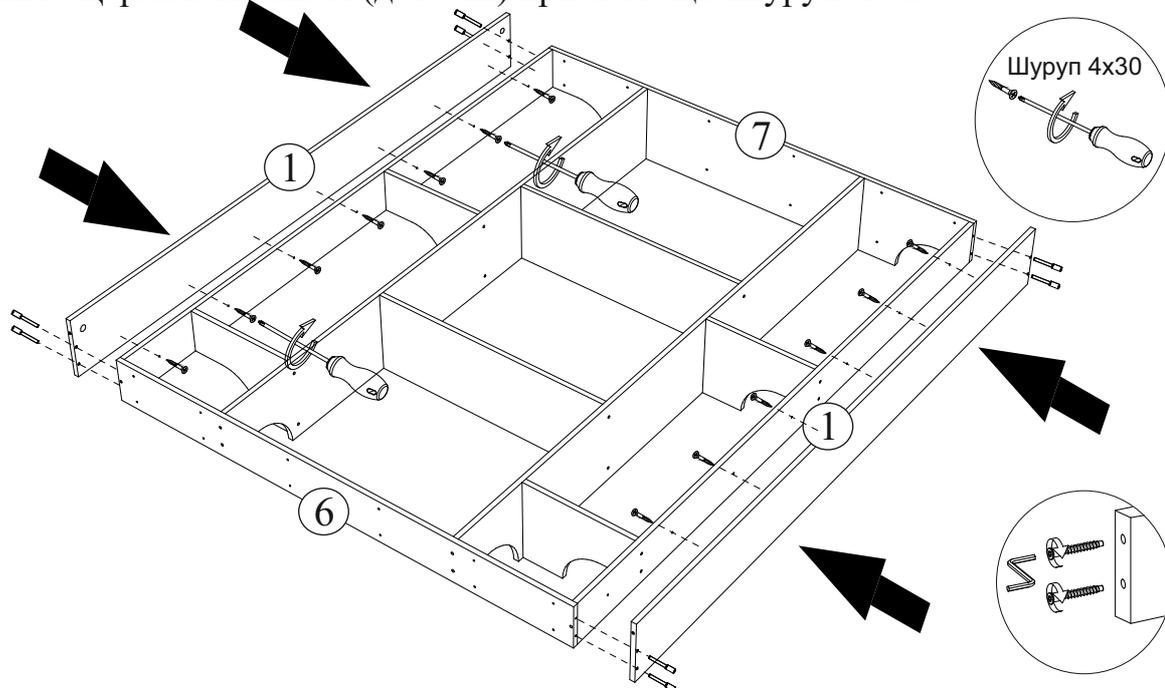
3. Вставьте Эксцентрики в Царги (дет. №1), Вверните Штока эксцентриков в Головной Головной щитки (дет. №4,9). Затяните Эксцентрики. Для усиления конструкции соедините Головной щиток (дет. №4) с Вязкой (дет. №7) а Ножной щиток (дет. №4) с Вязкой (дет. №6) при помощи Шурупов 4x30. Прибейте Подпятники гвоздями на нижнюю часть каркаса.
