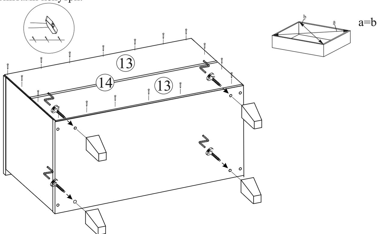
5. Соберите ящики соединив евроинтами Боковины ящиков (дет.№5,6) с Вязкой ящиков (дет. №7). Прикрутите Усиление ящика (дет. №8) к вязке ящика так же при помощи евроинтов. Вкрутите штока эксцентрики в Фасады ящиков (дет. №9,10,11). Соедините Фасады с корпусом ящиков затянув эксцентрики. Выровняйте диагональ и прибейте Дно ящиков (дет. №12). Прикрутите ответные части направляющих вровень с нижним краем боковин ящиков при помощи шурупов 4x16.
