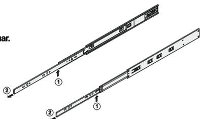
4. Прикрепите саморезами внешние неподвижные планки направляющих на боковые стенки корпуса в соответствии со схемой присадки.
