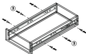
5. Вставьте ящик внутренними направляющими в подвижные части внешних направляющих в корпусе изделия. Задвиньте ящик до фиксации деблокировочным рычагом. Для снятия ящика также используйте деблокировочный рычаг.
