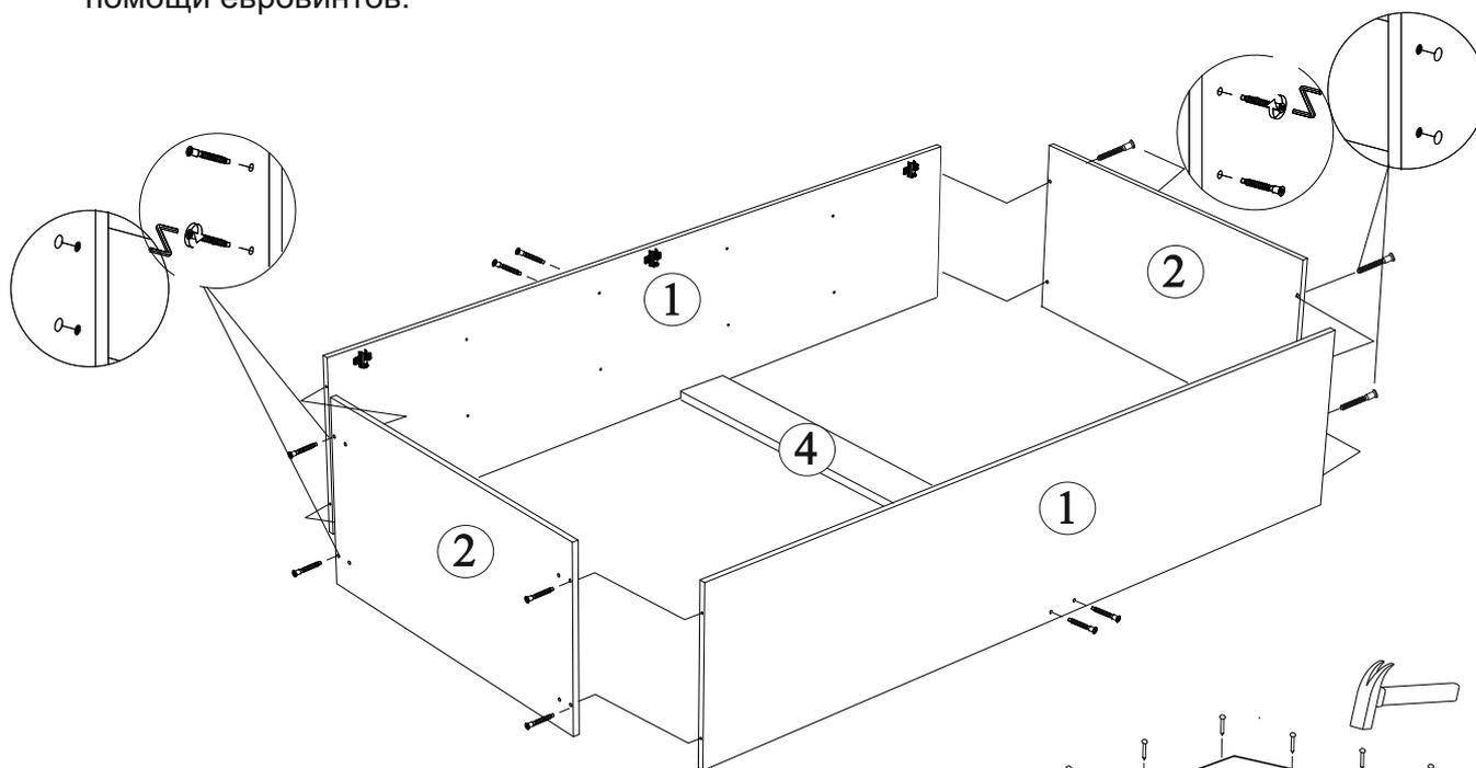
3. Выровняйте диагональ каркаса и прибейте Заднюю стенку ЛДВП ЛДВП (дет. №8) предварительно соединив их при помощи гвоздей. Установите Опоры при помощи евроинтов.
