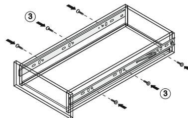
4. Прикрепите саморезами внешние неподвижные планки направляющих на боковые стенки корпуса в соответствии со схемой присадки.
