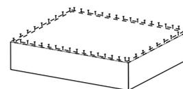
5. Установите вкладные петли на Створки (дет. №9,10) при помощи Шурупов 4x16.
