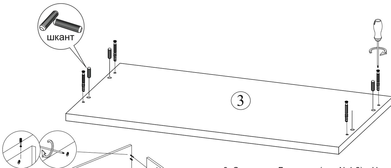
3. Соедините Боковины (дет. №1,2) с Нижней Крышкой (дет. №4) при помощи евроинтов. Затем присоедините Верхнюю крышку (дет. №4) при помощи эксцентриков и затяните их.
