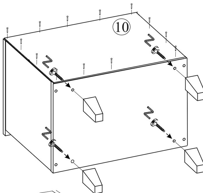
5. Соберите ящики соединив евровинтами Боковины ящиков (дет. №5,6) с Вязкой ящиков (дет. №8). Вкрутите штока эксцентриков в Фасады Ящиков (дет. №8). Соедините Фасады с корпусом ящиков затянув эксцентрики. Выровните диагональ и прибейте Дно ящиков (дет. №9). Прикрутите ответные части направляющих вровень с нижним краем боковин ящиков при помощи Шурупов 4x16.
