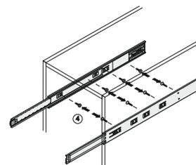
3. Закрепите саморезами внутренние подвижные планки направляющих к боковым стенкам ящика. Рекомендуется вкрутить один из саморезов в отверстие в форме звездочки
