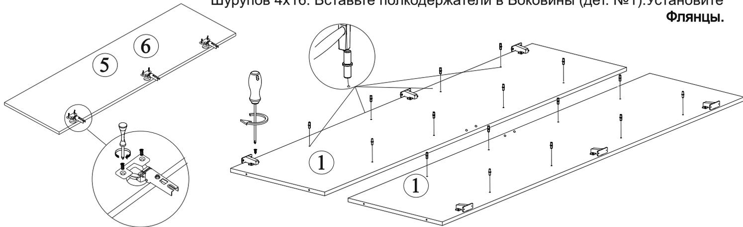
2. Соберите каркас шкафа соединив Крышки и Усиление (дет. №2,4) с Боковинами (дет. №1) при помощи евровинтов.
