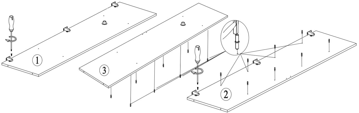
2. Соберите каркас шкафа соединив левый Бок и Перегородку (дет. №1,3) с Вязками (дет. №6) при помощи евровинтов. Не забудьте вставить Штангу (дет. №13) в Флянцы. Затем соедините правый Бок с Перегородкой (дет. №2,3) Вязками (дет. №6) так же при помощи евровинтов.
