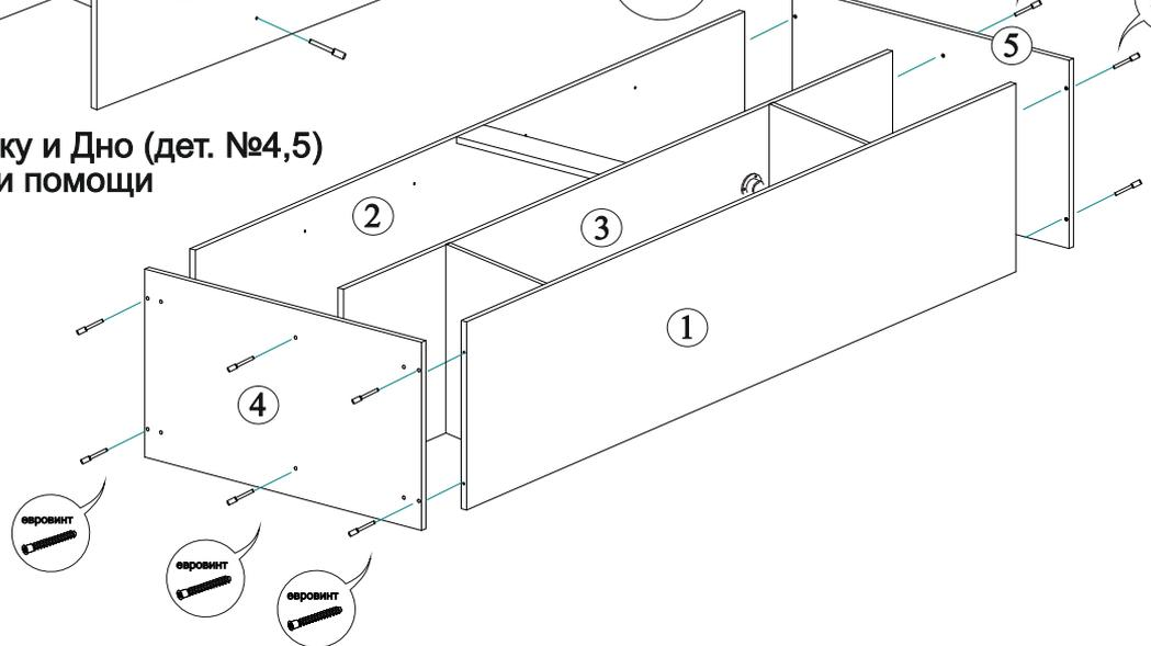
4. Выровняйте диагональ каркаса и прибейте Задние стенки ЛДВП (дет. №11,12) при помощи гвоздей. Установите Опоры так же при помощи Евровинтов.
