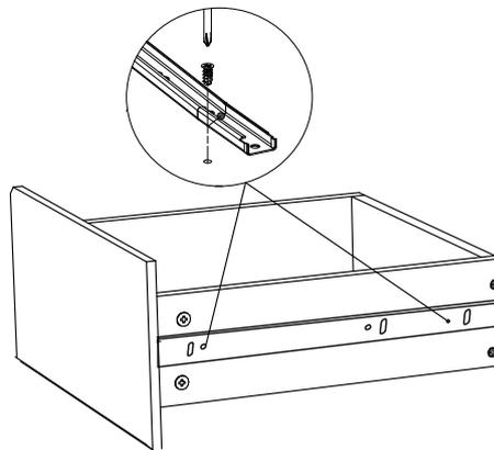
6. Установите ящик в корпус тумбы и отрегулируйте его.
