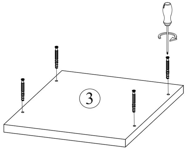
3. Соедините Боковины (дет. №1,2) с Нижней Крышкой (дет. №3) при помощи евровинтов. Затем присоедините Верхнюю крышку (дет. №4) при помощи эксцентриков и затяните их.
