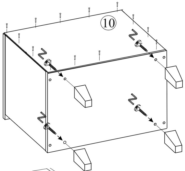
5. Соберите ящики соединив евровинтами Боковины ящиков (дет. №5,6) с Вязкой ящиков (дет. №8). Вкрутите штока эксцентрики в Фасады Ящиков (дет. №8). Соедините Фасады с корпусом ящиков затянув эксцентрики. Выровните диагональ и прибейте Дно ящиков (дет. №9). Прикрутите ответные части направляющих вровень с нижним краем боковин ящиков при помощи Шурупов 4x16.
