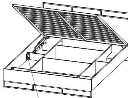
Уголок кроватный (508 Фрегат) 100x43x43 мм
