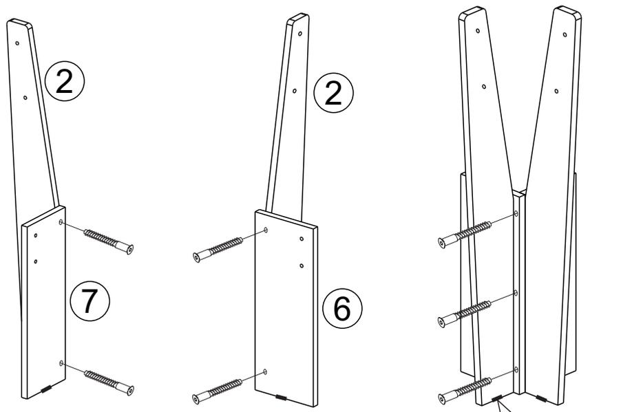
При необходимости досверлить отверстие Затянуть стяжку
