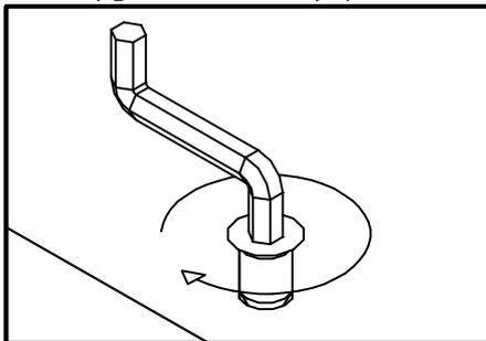
*Соединение эксцентриковой стяжкой*
