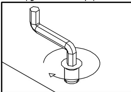
*Соединение эксцентриковой стяжкой*
