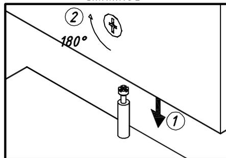
*Монтаж направляющей роликовой*
