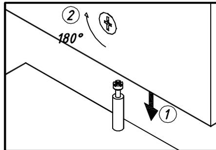
*Монтаж направляющей роликовой*
