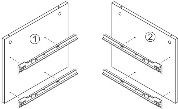
1. Сборка осуществляется горизонтально, тыльной стороной вниз. На боковины 1 и 2 установить направляющие 400 мм, евровинтами 6,3\*10,5 мм.
