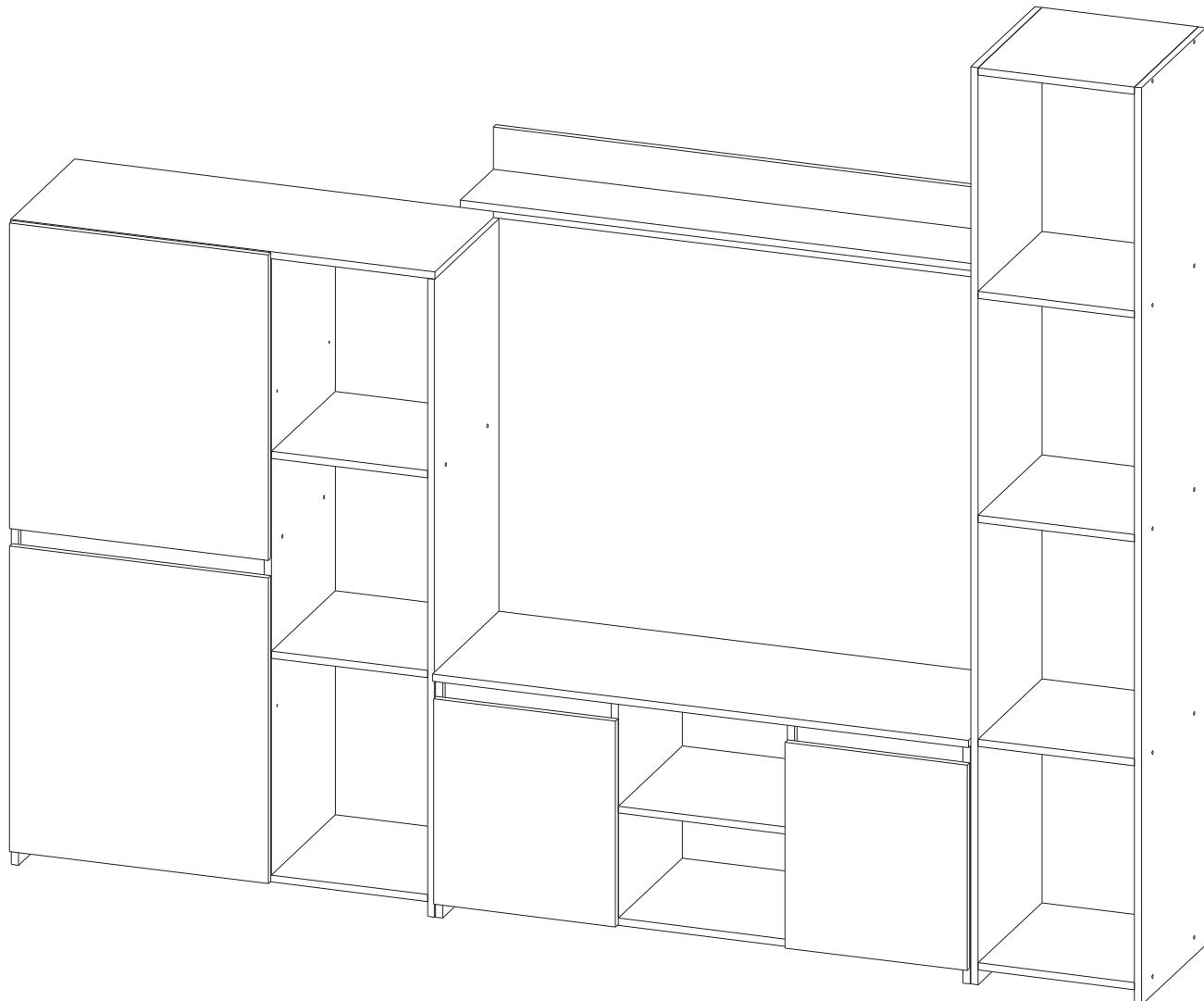
Универсальная сборка. Нагрузка на полку не более 5 кг при равномерно распределённой нагрузке.
